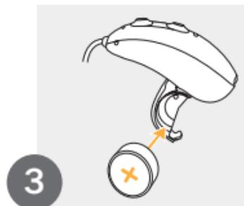
Coloque la pila en el portapilas con el símbolo “+” hacia arriba.
