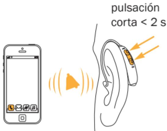
La llamada puede aceptarse mediante una pulsación corta en la parte superior o inferior del botón multifunción del audífono (menos de dos segundos) o directamente en su teléfono.
